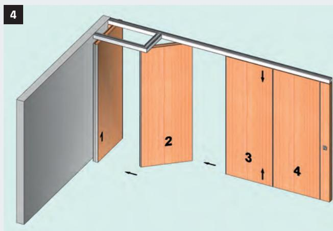
Fahren Sie auch dieses Element (Nr.2) soweit, bis die Rolle in der Schienenabzweigung steht und ziehen Sie gleichzeitig das Element (Nr.2) in Richtung Abfahrtschiene. Das Element (Nr.2) wird nun in die endgültige Parkstellung verfahren.
