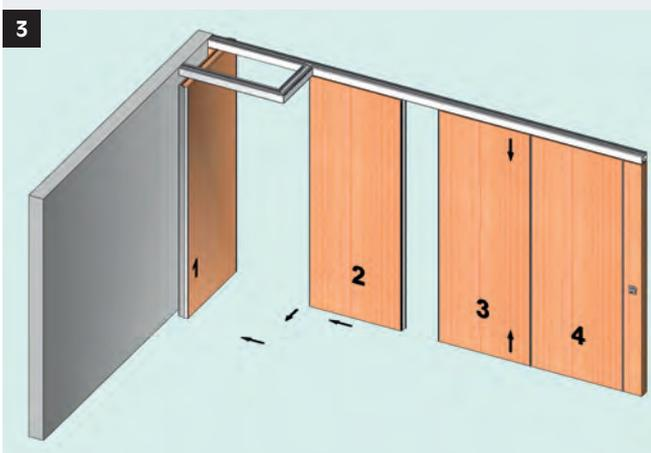
Sie können das Element (Nr.2) aus der Nut-Feder-Verbindung ziehen.
