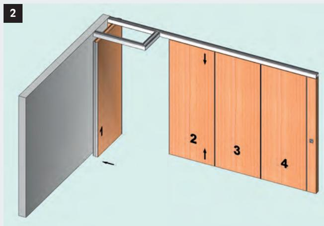
Fahren Sie das Teleskopelement (Nr. 1) in die endgültige Parkstellung. Die horizontalen Druckbalken des Elementes (Nr.2) fahren automatisch ein.
